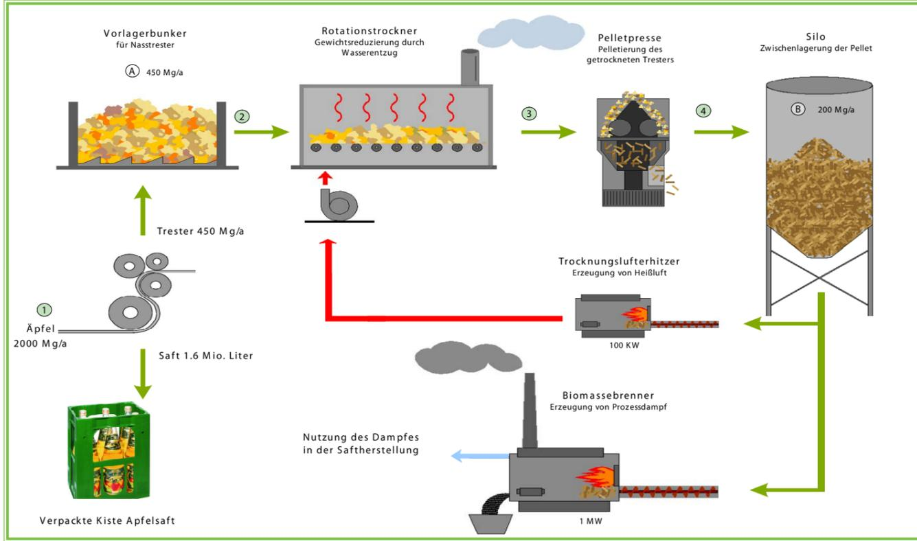
**A**pfeltrester, der bei der Produktion von Apfelsaft als Nebenprodukt anfällt, wird in der Saftkellerei Stiefel getrocknet und anschließend pelletiert. Durch die Verwertung der Pellets in einem Biomassebrenner kann der gesamte Heizenergiebedarf für den Produktionsbetrieb abgedeckt werden. Dabei werden jährlich rund 96.000 Liter Heizöl substituiert.
